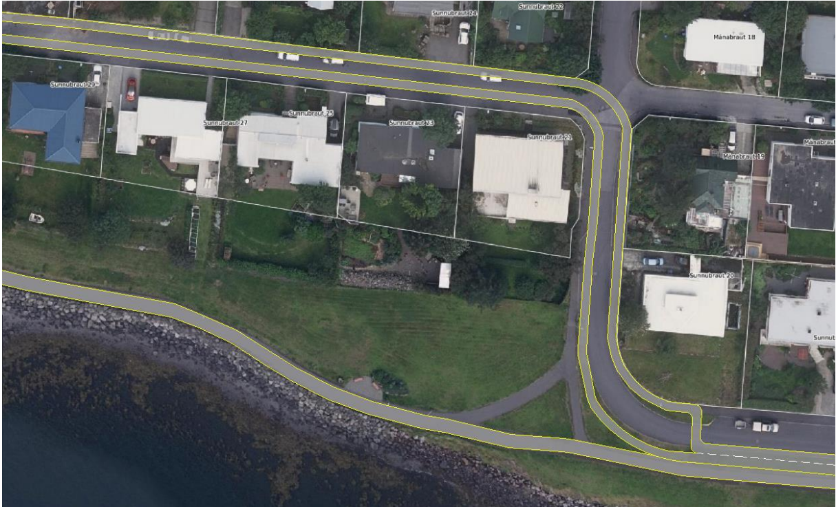
Mynd 20. Mögulegt fyrirkomulag að austanverðu. Hjólastígur þverar Sunnubraut, sem er einstefnugata á þessum stað, og fer um Suðurvör sem er með langhalla upp á 10-13%. Til vesturs er stígurinn einstefnu stígur sittthvoru megin götunnar þangað til gatan þregist við Kópavör. Milli Kópavara og Suðurarar yrði gatan gerð að einstefnugötu.
